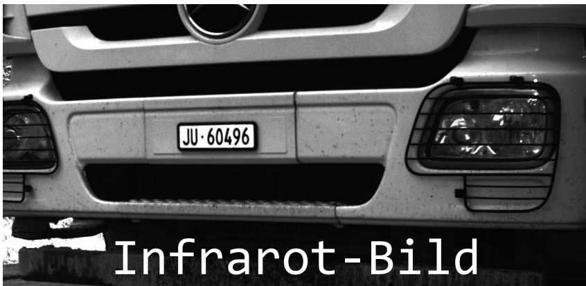
Bild: Dank Kamera und Infrarotstrahler sind Kontrollschilder bei allen Witterungen erkennbar.
